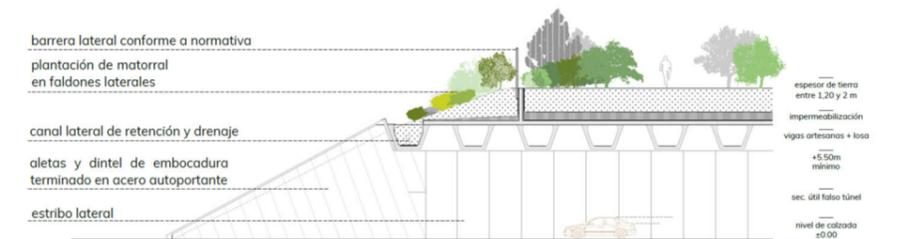
Figura 9. Sección tipo de borde embocadura
