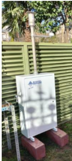
Equipo de captación de muestras para análisis de Benzo(a)Pireno.
