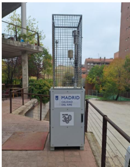
Cabina portable instalada en Ciudad Lineal.
