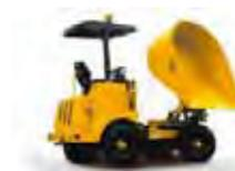
en obras pequeñas y medianas. En su mayoría son propulsados por motores diésel que entregan entre 5 y 50 kW, aunque una reducida proporción puede emplear motores de gasolina de 4 tiempos con entre 5 y 10 kW.
