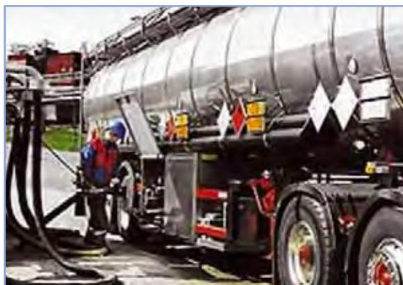
*Labores de llenado de un depósito de bioetanol*
